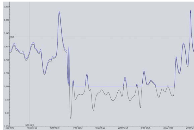
Couilly-pont-aux-dames (Grand-Morin), 09/2018- erreur de calibration du radar
